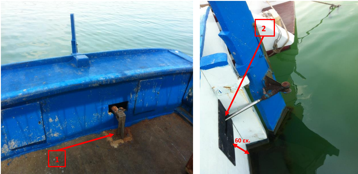
Εικόνα 4: Το σημείο έδρασης του μηχανισμού πηδαλίου (1) και το σημείο από το οποίο ο μηχανισμός διαπερνούσε το περίβλημα του σκάφους καταλήγοντας στην άρμωση με το πηδάλιο (2).
